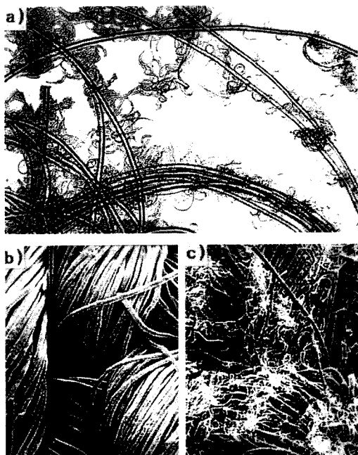
그림 10. 신인견 섬유의 피브릴화 현상: a) 초음파에 의해 발생된 1차 피브릴, b) 1차 피브릴을 제거한 직물, c) 2차 피브릴화된 직물.
