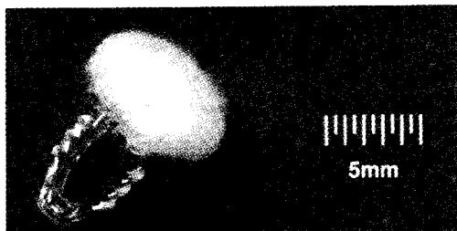
그림 3. PLA 사출성형품과 PGA 부직포를 조합하여 제조한 물렁뼈 세포 재건용 의료용용구.
