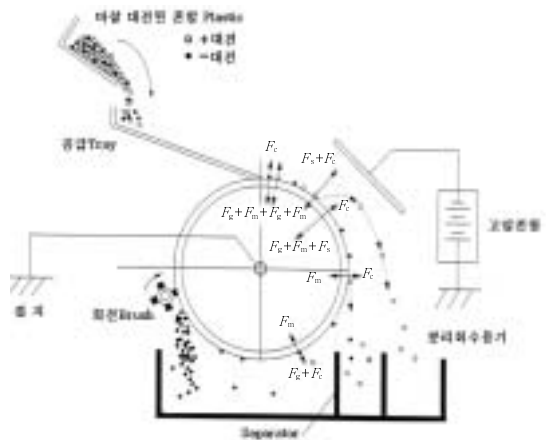
그림 6. 드럼전극접촉식 정전분리 기술의 원리도.
