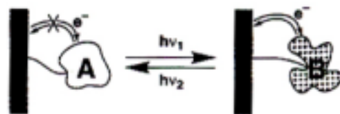
그림 4. 전극 부착 광전자분자가 광자극에 의하여 전자적 변환하는 모형.
