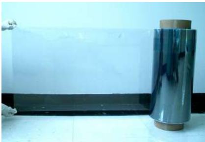
그림 3. 유기투명전극 필름 (디피아이솔루션스 PriMet TM , 코팅 방식 : roll-to-roll, 투과율 87%, 700 \Omega/\text{sq} ).
