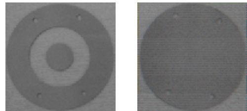
그림 2. 측정에 사용되는 시편의 모양; (a) 기준 시편, (b) 부하 시편.
