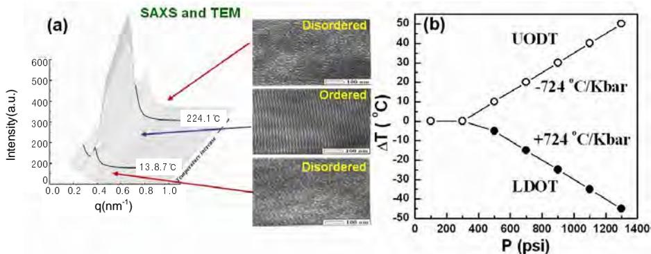
**그림 1.** (a) 단힌 루프 구조의 상거동을 가지는 Polystyrene-block-poly(n-pentyl methacrylate) 블록 공중합체의 온도에 따른 소각 X-선 산란 강도 변화와 TEM images. (b) 이 블록 공중합체의 압력에 따른 나노 구조 생성 온도의 변화.
