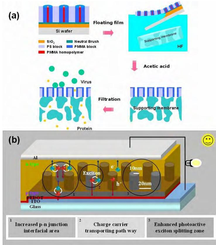
그림 2. 실린더가 수직으로 배향된 박막을 이용한 (a) 바이오 물질 분리막과 (b) pn heterojunction Photovoltaic Cell로의 응용.
