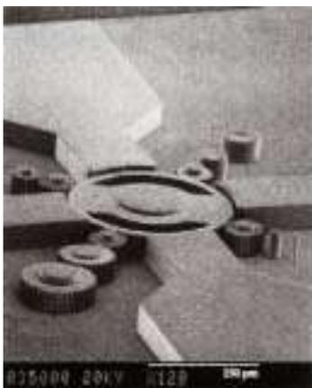
**그림 4.** LIGA 공정으로 제조한 니켈 구조물의 SEM 사진.<sup>30</sup>
