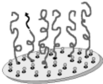
그림 25. The schematic diagram of polymer "Grafting from".
