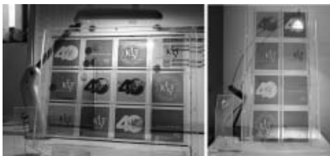
그림 8. KIST 제작 투명 컬러 염료감응 태양전지 윈도우.
