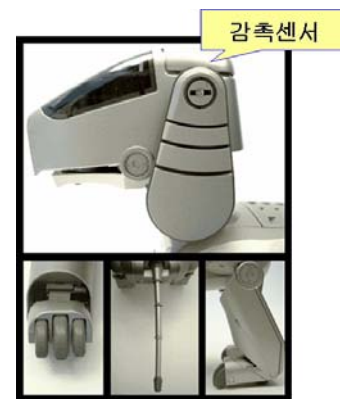
그림 12. 실용화 예로 소개한 Sony의 [AIBO]로봇. 머리부에 감촉센서로 탑재되어 있음.
