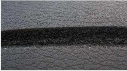
그림 27. Core back 방식으로 발포된 성형품 단면 사진.
