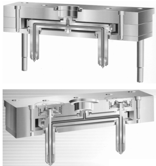
그림 18. Gate types in the hot runner system.
