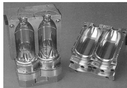
그림 30. Mold for injection stretch molding for carbonated soft drink.
