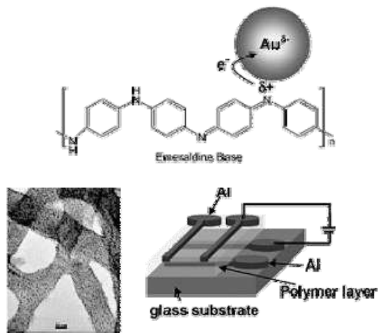
그림 4. PANI-Au 나노입자의 전자 전달 메커니즘, TEM 및 메모리 소자의 모식도. 12
