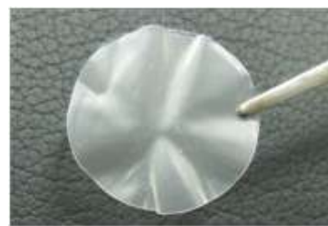
그림 3. 필름 형태의 생체재료를 제작하였는데 제작된 생체재료는 3~15 cm로 크기를 다양하게 조절가능하며, 세포를 배양하여 만든 재료로서 20~150 \mu\text{m} 높이를 보이며 크기에 따라 다양하지만 3~30 \mu\text{g} 의 무게로 얇은 필름 형태이며 30~100 N의 인장강도가 측정됨.
