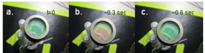
그림 6. Bragg 반사판의 수분 노출에 따른 색 변화. 초기에 수분이 없을 때에는 녹색을 띠는데(a), 수분에 노출되면 고분자 박막층의 두께가 부풀어 증가함에 따라 장파장의 적색으로 변하고(b), 다시 수분을 제거하면 원래의 색인 녹색으로 돌아간다(c). 반응 속도 역시 수 초 이내로 대단히 빠르다.
