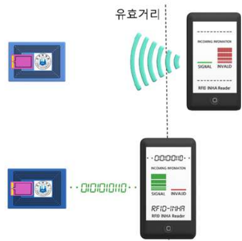
그림 7. RFID 태그와 리더기간 무선 데이터통신 기술.
