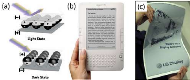
그림 9. (a) 트위스트 볼을 이용한 전자 종이 동작 원리, (b) 아마존에서 출시된 전자책 '킨들', (c) LGD에서 개발한 플렉시블 E-paper.
