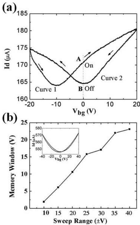
**그림 4.** 그래핀 기반 니켈 나노결정 메모리 소자의 특성: (a) 드레인 전압 1 V, 게이트 전압 -20 V에서 +20 V내 전류 특성 커브, (b) 니켈 나노 결정이 없는 경우의 sweep range에 따른 메모리 윈도우.
