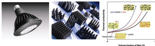
그림 4. 열전도성 고분자재료의 적용 예: (a) LED용 하우징재료, (b) 전자제품용 히트싱크, (c) 하이브리드필러 시스템을 이용한 열전도성 고분자재료.
