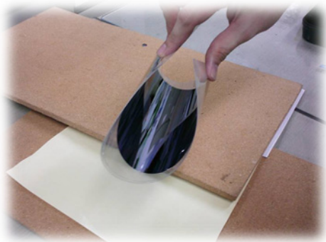
그림 7. PET 필름에 의한 두께 75 \mu\text{m} 실리콘 웨이퍼 휨(warp) 테스트 (서울대 접착과학 및 바이오복합재료 연구실 자료).
