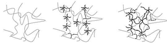
그림 9. UV 경화에 의한 다관능성 모노머의 가교 반응 모식도. 22
