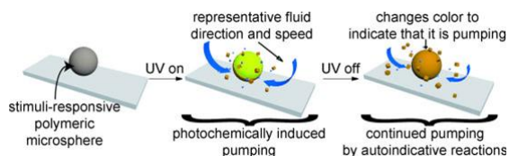
그림 1. 자극 반응성 폴리머 미세구체의 구동 과정을 보여주는 모식도. 폴리머 속에 자가 유도성, 자전적(self-propagating) 반응을 직접적으로 만들기 위해서 자극의 존재를 기억할 수 있는 자극 반응성 재료를 사용하였다. 이런 개념의 증거로서, 비기계적, 폴리머 기반의 펌프는 잠깐 동안의 신호에 노출될 때, 폴리머 주위의 액체를 펌프할 수 있다.
