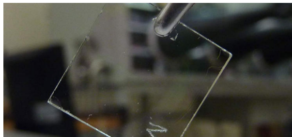
그림 3. 우표 크기의 유리 상에 형성된 유리 트랜지스터들 상의 투명 트랜지스터들은 실리콘 트랜지스터들의 몇몇 특성들에 필적하는 특성들을 발표했다. 소자는 저렴하면서 투명한 전자 소자의 차세대 개척하기 위하여 세계 최초의 유기 트랜지스터를 만들기 위한 새로운 공정을 사용하였다.
