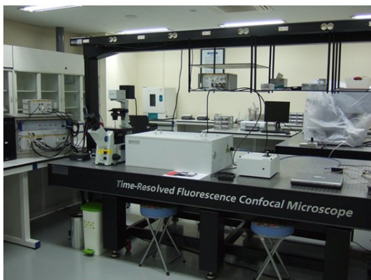
그림 2. 한국기초과학지원연구원 강릉센터에 설치된 시분해 형광 공초점 현미경 사진.
