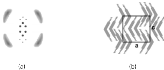
그림 6. (a) 배향시킨 B1 상의 2D X-선 패턴, (b) B1 상에서 제안된 분자 배열 구조: columnar phase의 2D rectangular cell 모형.
