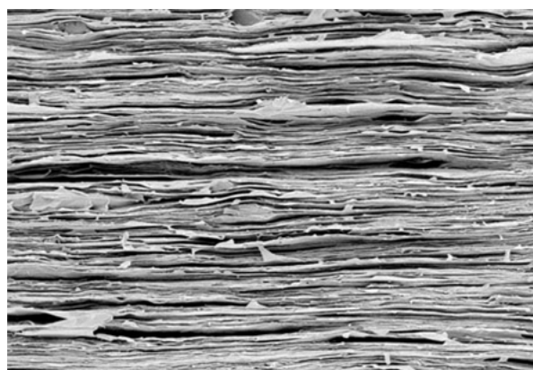
그림 3. 전자 현미경으로 관찰한 진주층 모방 재료의 구조.
