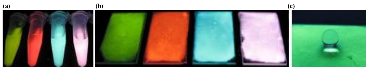
그림 11. (a) 용액에 분산된 상태, (b) 유리기판 위에 코팅된, (c) 물방울과 함께 있는 콜로이드 입자 위의 양자점과 형광 염료를 담지한 블록 공중합체 마이셀 다층초박막.
