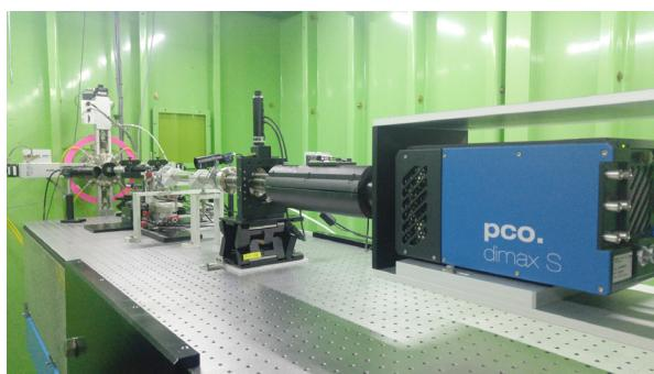
그림 2. 포항방사광가속기 초고속 엑스선 나노영상 빔라인(7C) 모습. 46 nm 공간분해능과 이미지 당 0.04초 시간분해능을 보유한 초고해상도 초고속 엑스선 현미경. 엑스선 현미경을 활용하여 마이크로 입자와 고체 기판 사이에서 0.1초 동안 발생하는 초미세 물의 증발을 정밀하게 관찰할 수 있다.<sup>6</sup>
