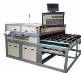
그림 10. K5500 solar module EL inspection system.
