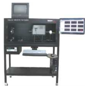
그림 10. M6000 OLED lifetime test system.
