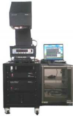
그림 3. K3000 solar cell efficiency measurement system.
