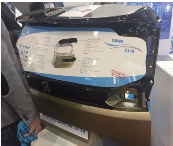
그림 7. 복합소재를 적용한 경량 테일게이트(DMM). 11
