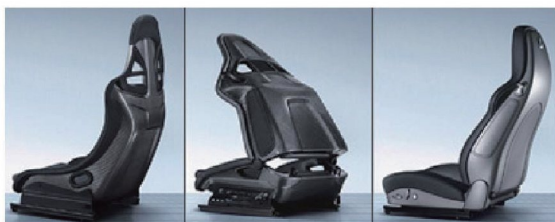
그림 6. 탄소섬유를 적용한 포르쉐 Carrera GT 시트 프레임. 2,9
