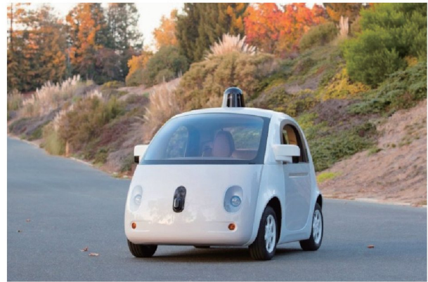
그림 15. 천정 중앙에 360도 회전식 LIDAR 센서를 장비한 Google의 자율주행자동차. 19
