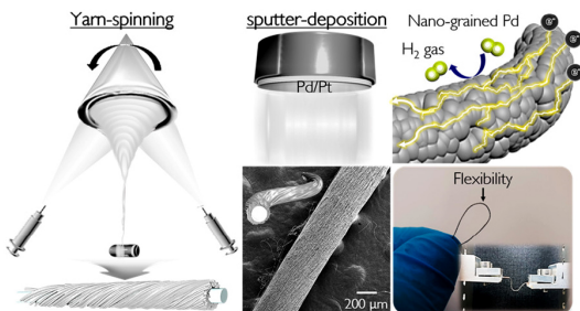
그림 1. 금속 코팅된 나노섬유/원사 제작 모식도 및 원사 사진.
