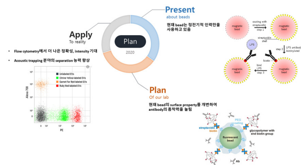
그림 3. Flow cytometry용 입자 제작 및 반응 메커니즘.
