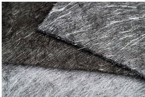
그림 4. 열분해 방식으로 회수된 ELG사의 재활용 탄소섬유. 18
