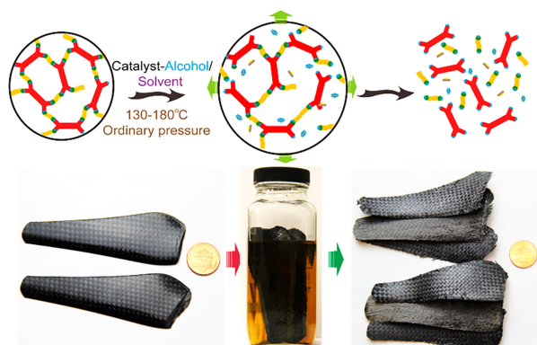
그림 7. 산무수물계 경화제 기반 에폭시(anhydride-epoxy) 복합재의 화학적 재활용. 15
